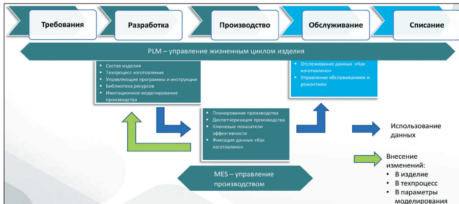
Рис. 2 Обмен данными между PLM и MES системами на этапах жизненного цикла изделия («правильное» взаимодействие систем)
